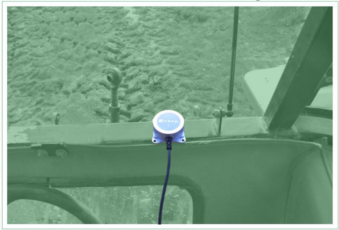
车身陀螺仪安装时应选择驾驶室内平整、坚固、震动小、不易触碰得位置，固定时保证引出线向前，
