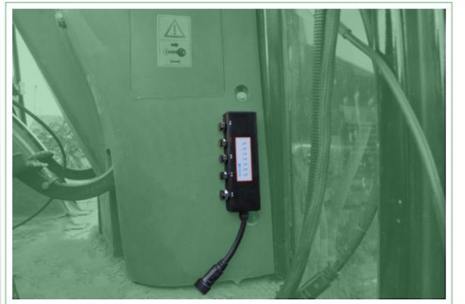
建议安装在控制台右侧稳定位置
